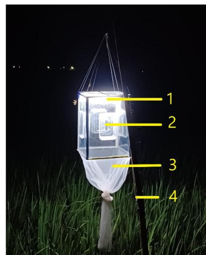
**Gambar 1.** Kurungan perangkap lampu untuk mengoleksi ngengat betina aktif *Scirpophaga incertulas*. Bagian kurungan perangkap: 1: lampu LED; 2: lubang masuk ngengat; 3: kain kasa penampung ngengat; 4: tiang pancang.
